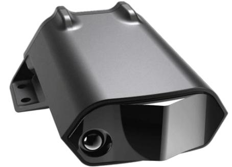
Die Antenne wird an der Vorderseite des Fahrzeugs in der Regel hinter der Kunststoff-Stoßstange oder hinter dem Kühlergrill vor dem Fahrzeugkühler montiert. In Fahrtrichtung und idealerweise 30-50cm über dem Boden. Wenn Sie die Antenne so montieren, dass die Stoßstange davor ist, überprüfen Sie das Material, aus dem die Stoßstange gemacht ist und ob diese eine Metallverstärkung enthält.
